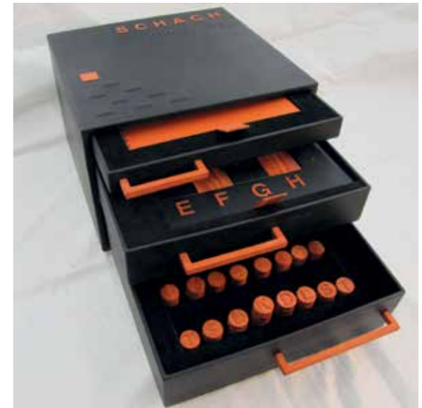
Meisterstück von Nicole Schäfer, Römerstein Für Sehbehinderte geeignetes Schachspiel mit Behältnis Schachspiel aus Padouk-Furnier und schwarzem Ziegenleder, Vierteiliges magnetisches Spielbrett, Braille-Schrift als Unterlage, Schwarzschrift als Auflage, magnetische Figuren. Behältnis mit drei Schubladen für Spielanleitung, Spielfeld und Figuren.
